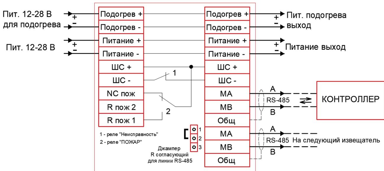
Рисунок 9 – Схема подключения по интерфейсу RS-485
