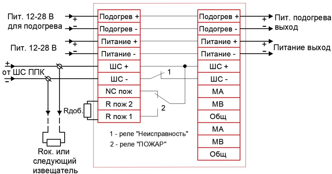
Рисунок 8 – Схема подключения без использования режима «НЕИСПРАВНОСТЬ»
