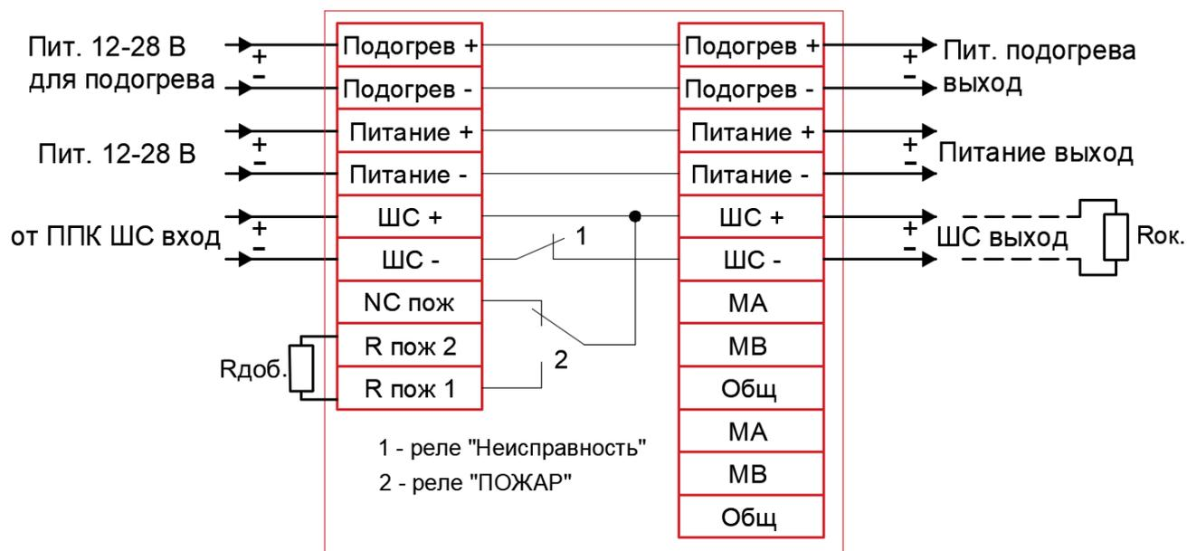
Рисунок 7 – Схема подключения с использованием режима «НЕИСПРАВНОСТЬ»
